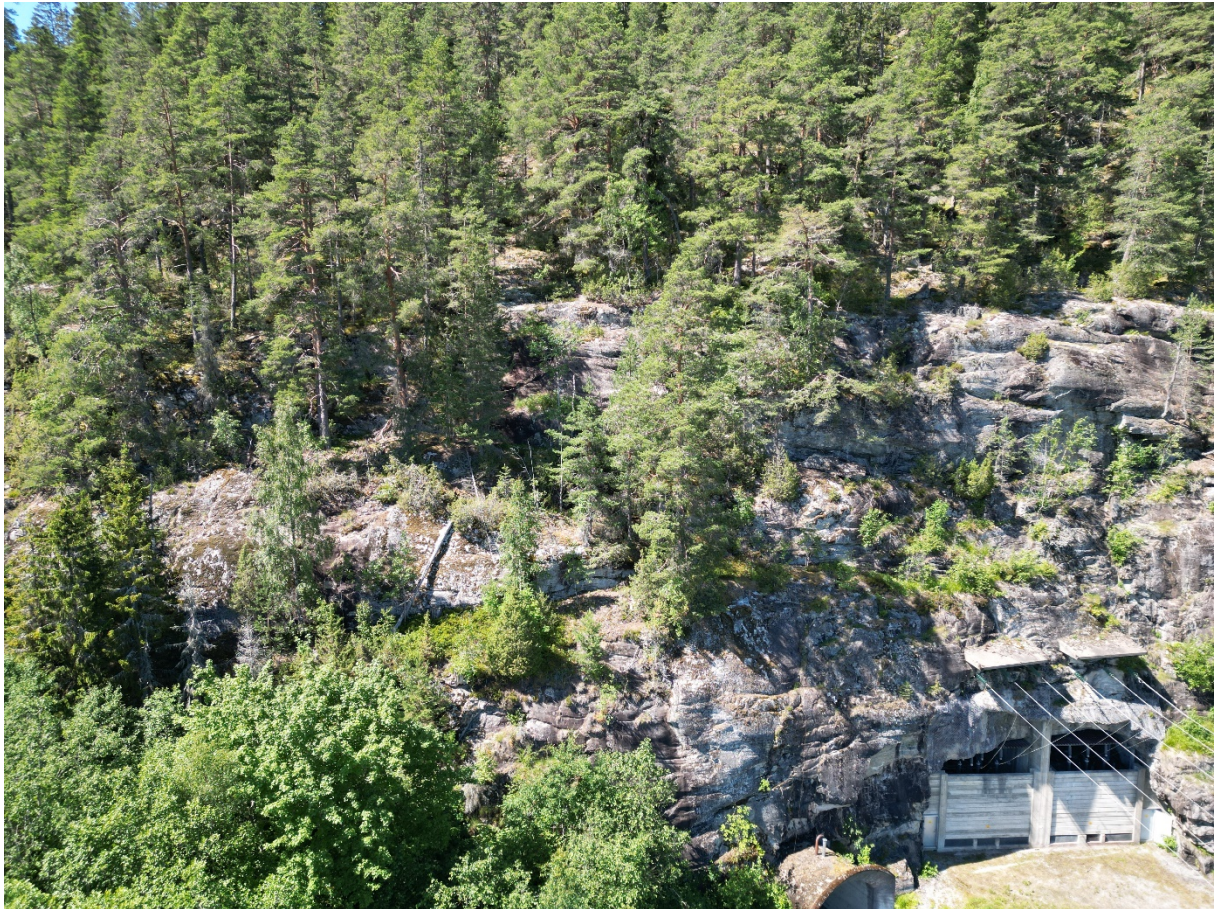
Figur 3: Dronefoto av terrenget på oversiden av mulig tunnelpåhugg. Bilde viser skurt bart berg i de bratteste partiene, og vegetasjon med busker, lyng og furutrær på mindre bratte terrasser.
